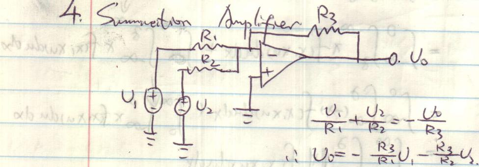
$$\frac{U_1}{R_1} + \frac{U_2}{R_2} = -\frac{U_o}{R_3}$$
